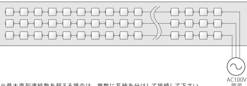
※最大直列連結数を超える場合は、複数に系統を分けして接続して下さい。
